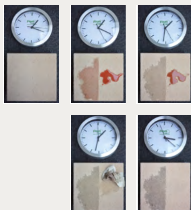
Linke Steinhälfte ohne Imprägnierung, rechte Steinhälfte mit Imprägnierung, Wirkungsweise einer Imprägnierung im zeitlichen Ablauf.
